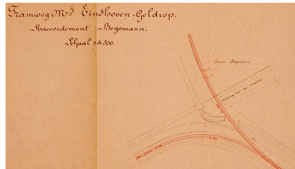
Situatietekening van de spooraansluiting van de fabriek van Begemann aan de tramweg Eindhoven - Helmond. Links de rails van de tramweg die met een flauwe bocht een uiteindelijke boogstraal van 60 graden (r60) maken om de (hier nog niet van een straatnaam voorziene) zijweg in te gaan. Het van boven komende drierailig spoor - voor 1067 mm en 1435 mm - van het terrein van Begemann sluit op de nieuwe weg aan op de tramrails vanwaar het drierailig verderloopt. (Nationaal Archief, Ministerie van Waterstaat, Afdeling Spoorwegen, toegang 2.16.23.01, doos 190)
